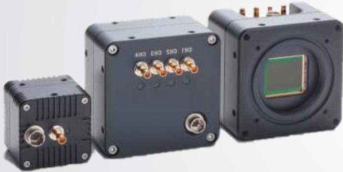
STC-MCS502CXP121是一款高性能的500万像素彩色CMOS工业相机，在工业图像采集领域展现出卓越的实力。采用先进的1/1.8英寸Sony IMX547图像传感器，分辨率为2448(H)×2048(V)，在全分辨率下最高帧率达到123.9fps，能够捕捉高速运动中的目标物体细微之处和复杂结构，彻底杜绝图像卡顿和拖影问题，确保图像质量。
