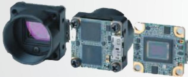
STC-BBS43U3V-BC是一款 510 万像素的 USB3 Vision 接口的黑白相机。它采用索尼的 IMX287传感器与先进的CMOS全局快门技术，在工业图像采集领域占据重要地位。分辨率高达 720(H) × 540 (V)，在全扫描模式下，8bit 输出时帧率可达 527.1fps，能够快速捕捉动态画面，满足对高速运动物体的监测需求。
