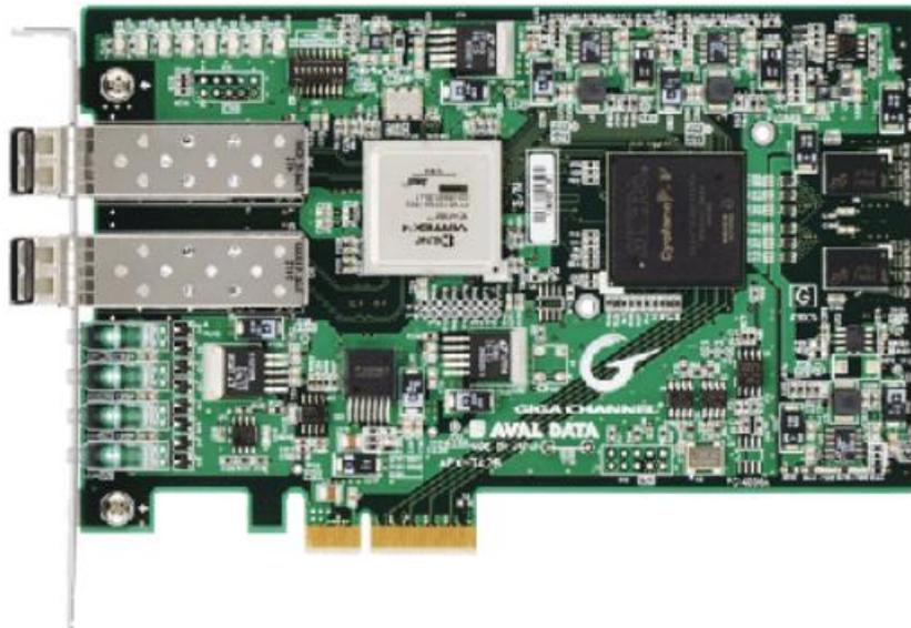
APX-742B 这块光通信板能够在多个系统之间利用光链路电缆高速共享信息。由于通信所需的所有协议处理都是在硬件中进行的，因此减轻了软件的负担，系统建设也可以很容易地进行。支持 PCI Express 2.1 x 4。
