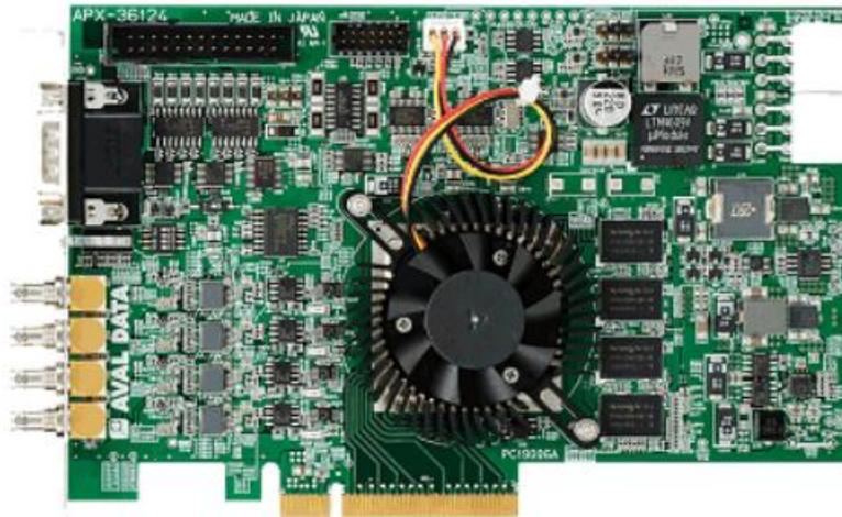
APX-36124 是由日本 AVAL DATA 公司制造的符合 CoaXPress 2.0 规范、支持 CXP-12 Quad 1Ch , Dual2Ch, Single 4Ch 的采集卡, 一个四通道摄像机, 每通道 12.5Gbps, 两个双摄像机, 最多四个单摄像机支持 PCI Express 3.0 (Gen3) 8GT/s×8, 可在 PC 上快速获取图像板载配备 DDR4 SDRAM 2GB, 可用作 FIFO 存储器或工作存储器.
