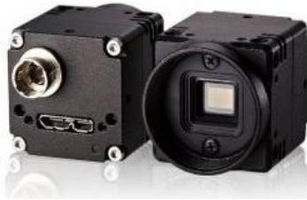
STC-MBCM200U3V 黑白工业相机是日本 Sentech 设计生产的 USB3.0 接口工业相机，采用 200 万像素 2/3 英寸 CMOS 图像传感器，具有硬件触发采集功能，是一款外形极小的工业相机。8~12bit 灰度图像输出，全帧曝光，帧率高达 167 帧/秒，该工业相机在高速抓拍应用上能挥其良好的性能。
