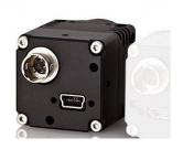
STC-MB152USB 黑白工业相机是一款 150 万像素、超小体积的 MiniUSB 工业相机,该工业相机外观精巧,具有高刚性,且价格合理。相机本身具有硬件触发采集功能,采用高灵敏度 1/2 英寸 CCD 图像传感器,分辨率 1360×1024,帧率达 19 帧/秒,图像质量高。相机四面均设计有安装孔,安装操作使用简单和二次开发包方便易用。
