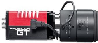
Prosilica GT 1290C 彩色工业相机是德国 AVT 生产的 120 万像素千兆网接口工业相机，专门用于极端温度条件和照明波动变化环境。提供精确自动光圈控制，用户可通过固定孔径值来优化景深、曝光时间和增益值，而无需额外的控制单元。GT 1290 采用高品质的 Sony ICX445 EXview HAD CCD 传感器，可以获取高质量的图像。
