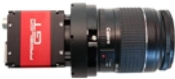
Prosilica GT 1930L-C 彩色工业相机是德国 AVT 生产的 240 万像素千兆网接口工业相机，采用全局曝光 Sony IMX174 CMOS 图像传感器。Prosilica GT 系列产品均带有精确自动光圈控制和 DC 驱动自动光圈功能，支持通过网络接口供电，并采用了最新的 CCD 传感器技术，使得 Prosilica GT 系列工业相机成为很多环境恶劣的应用的理想选择。
