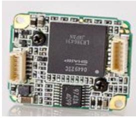
STC-N64D 模拟彩色工业相机是一款 40 万像素 TV 格式裸板工业相机，采用 1/4 英寸 CCD 图像传感器 (Sony ICX648BKA)，隔行扫描工作方式。该相机适用于内嵌式的视觉设备，可以选择 CS 接口、f=2.3mm 固定镜头或不带镜头。
