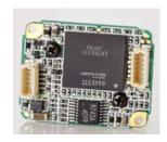
STC-P54B 模拟彩色工业相机是一款 25 万像素 TV 格式裸板工业相机,采用 1/4 英寸 CCD 图像传感器(RJ2421AB0PB),隔行扫描工作方式。该相机适用于内嵌式的视觉设备,可以选择 CS 接口、f=2. 3mm 固定镜头或不带镜头。
