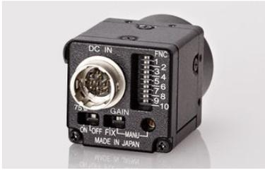
STC-MB202A 模拟工业相机是 STC-A202A 的替代产品，是体积最小、重量最轻的逐行扫描黑白工业相机。采用 1/1.8 英寸 CCD 图像传感器，感光效果好，成像质量高，是一款性价比比较高的工业相机产品，且安装使用简单。
