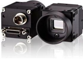
STC-MC152PCL 彩色工业相机是 STC-CLC152A 和 STC-POCLC152A 的替代产品，具有硬件触发采集功能。该工业相机采用的 1/2 英寸 CCD 图像传感器，Base Camera Link 接口输出，通过 Camera Link 图像输出和相机参数控制。此工业相机外观精巧，采用金属外壳，4 面均设计有安装孔，安装和使用非常方便。
